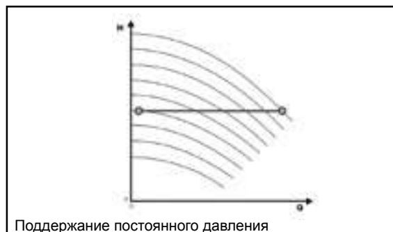
Поддержание постоянного давления
