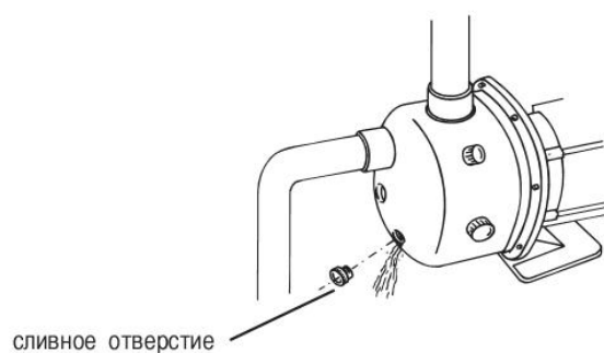
Рис. 7 Осушение рабочей полости насоса
